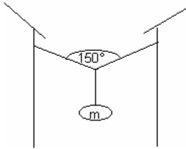
Eine Straßenlaterne der mit der Masse  $m = 20,4 \text{ kg}$  wird zwischen zwei Häusern symmetrisch aufgehängt. Welche Zugkräfte müssen die Haken in den Hauswänden aushalten?
