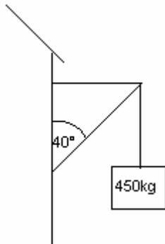
Berechne die bei dem abgebildeten Ladekran auftretenden Druck – und Zugkräfte!
