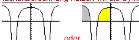
Die Seitenfläche der Brücke ist das Rechteck  $20\text{m} \cdot 10\text{m} = 200\text{m}^2$  vermindert um zweimal die graue und zweimal die gelbe Fläche.
